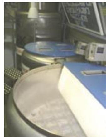
Die fachgerechte und sichere langfristige Verwahrung von Proben in einer Kryobank erfolgt in großen stickstoffgekühlten Spezialbehältern (Quelle: Cryo-Bank in Krefeld der AIR LIQUIDE Medical GmbH).
