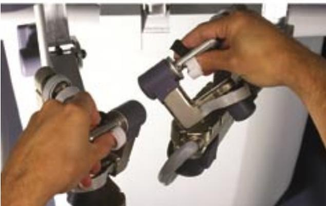
Abb. 1a + b: Bedienung der abwinkelbaren Instrumente über die Bedienelemente.
